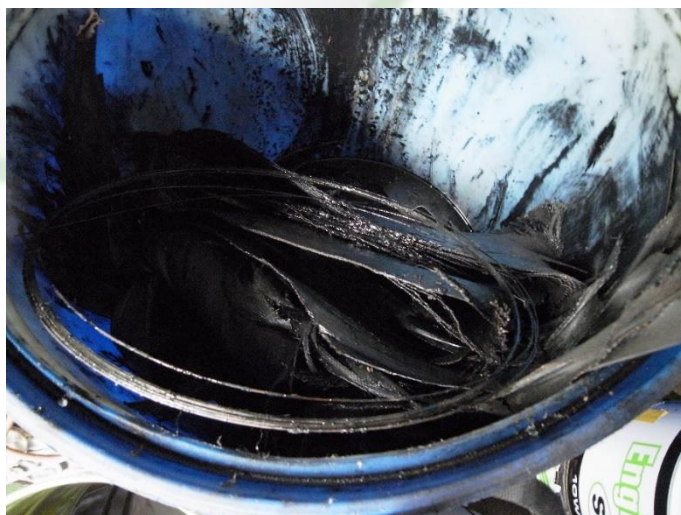
『溶解液を入れたドラム缶にタイヤを浸けたもの』
